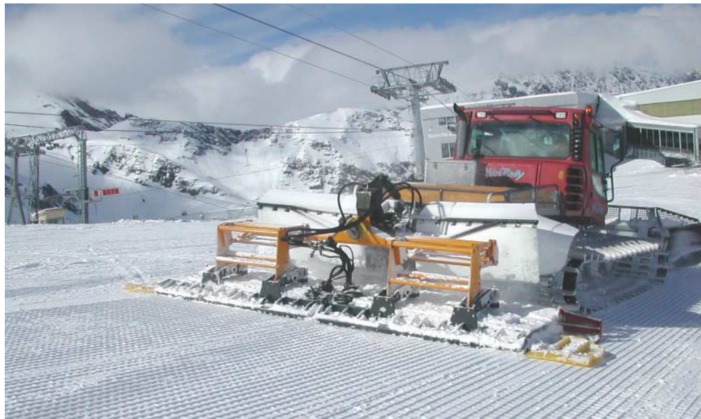
Schneeverdichtung mittels Rüttelplatten (Bomag-Snow-Plate)
